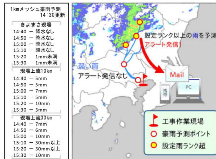
KIYOMASAは1日288回更新。全国どこでも1kmメッシュで豪雨と降雪(冬季)を5分毎に予測します。降水の実況を随時取り込むことで、高精度のリアルタイム豪雨・降雪予測を可能にしました。現場の緯度経度を登録しておくことで、常に現場上空の気象変化を監視でき、局地豪雨や集中豪雨対策に有効です。降水の強さを16段階で予測しており10mm以下については1mm単位で判別し、2mmや4mmといったコンクリートの打設可否判断に活用しやすいようにしています。また、設定ランク以上の降水が予測されると、瞬時に現場にアラートメールで通知します。河川工事の場合、上流に発達した雨雲が予測された時点で、たとえ下流にある現場に雨が降っていなくてもアラートメールが発信されます。集水地点や河川の合流地点など複数豪雨予測ポイントを持つことができます。
